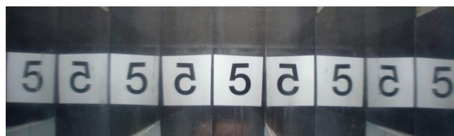
図 2 5 : 鏡の高さ 1 2 cm、2 枚の鏡の間隔 1. 5 cm
