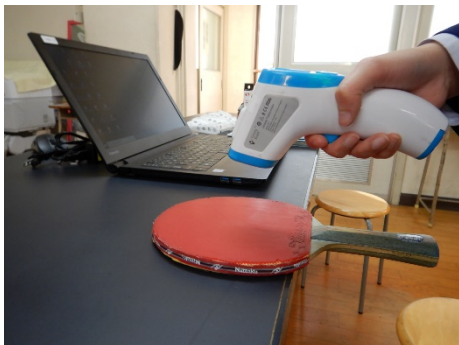
図1 非接触温度計でラバーの温度を測定
